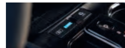
КОМФОРТНЕ ВОДІННЯ З ТЕХНОЛОГІЄЮ e-PEDAL STEP* Технологія e-Pedal Step від Nissan дозволяє ефективно прискорюватись та уповільнюватись на швидкості понад 10 км/год за допомогою лише педалі газу. Педаль гальмування використовується для більш різкого гальмування і для повної зупинки.
